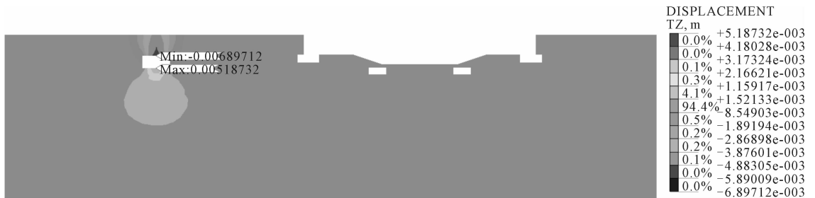
图 6 顶管顶进 45 m 土体横切面竖向位移云图
