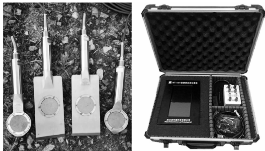
图1 铲状孔压探头和测试仪器实物图
